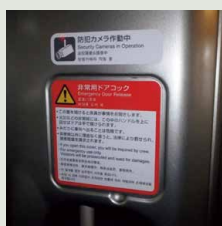
【新幹線の非常用ドアロック設置例】
