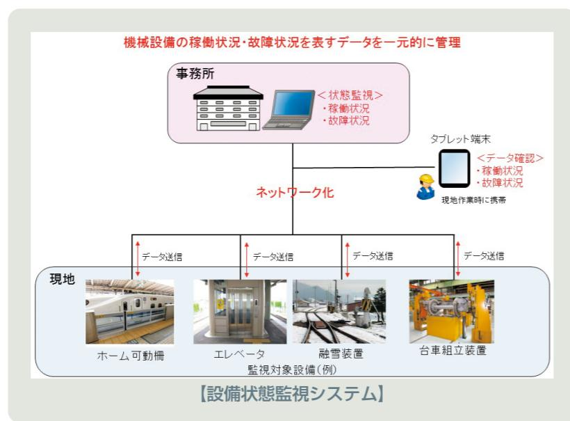
ム可動柵、エレベータ、台車組立装置等を遠隔でリアルタイムに把握できる設備状態監視システムを順次導入し、故障発生時の復旧作業の迅速化を図っています。
