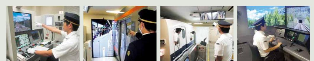
【運転士訓練シミュレータ（在来線）】【車掌訓練シミュレータ（在来線）】【駅輸送・車掌訓練シミュレータ（新幹線）】【異常時訓練シミュレータ（新幹線）】
