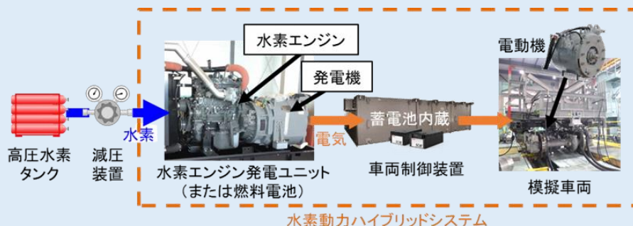
水素エンジンハイブリッドシステムの構成
