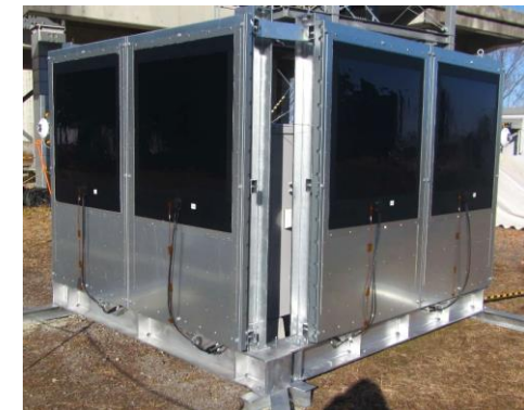
実証実験中のペロブスカイト太陽電池付き防音壁
