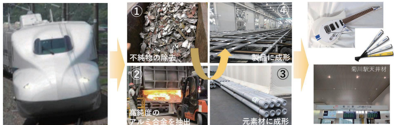
東海道新幹線再生アルミの活用例（ギター・バット・駅舎天井材） ※②、④はSUS（株）、ギター画像は東海楽器製造（株）、バット画像はミズノ（株）提供
