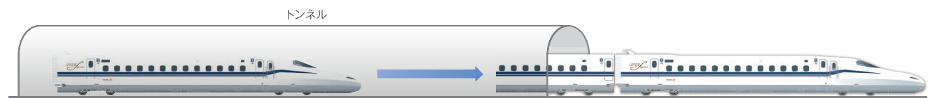
図3 バッテリー自走システムの搭載
