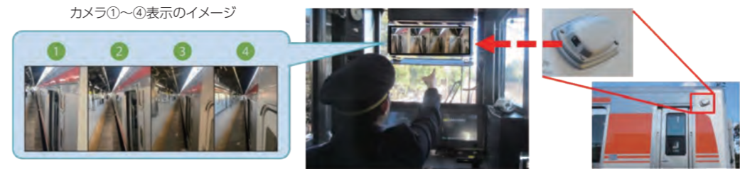
カメラ①～④表示のイメージ (例)列車に接近した人物を検知、音等で運転士に通知
