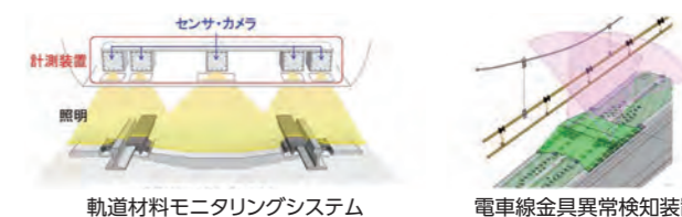
軌道材料モニタリングシステム
