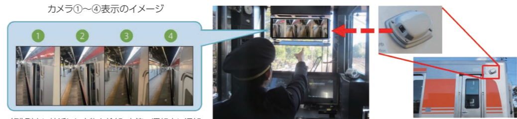
カメラ①～④表示のイメージ (例)列車に接近した人物を検知、音等で運転士に通知
