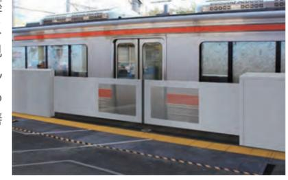
可動柵設置のイメージ(写真は金山駅の試作機)
