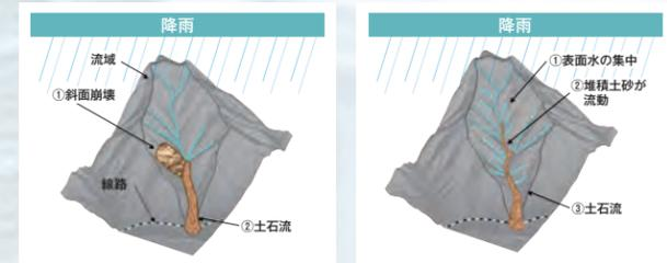
図 土石流の発生形態(左:崩壊型土石流 右:渓床流動型土石流)
