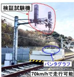
図 14 レーザ式 すり板計測検証試験機
