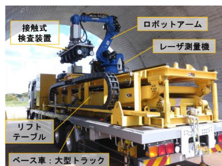
写真2 トンネル検査ロボットの全景
