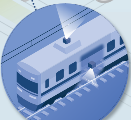
画像認識等を活用して線路や 電車線設備の状態をモニタリング
