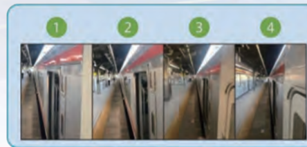
(例)列車に接近した人物を検知、音等で運転士に通知
