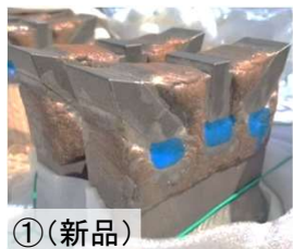
カッタービットの摩耗状況
