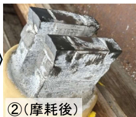
カッタービットの摩耗状況
