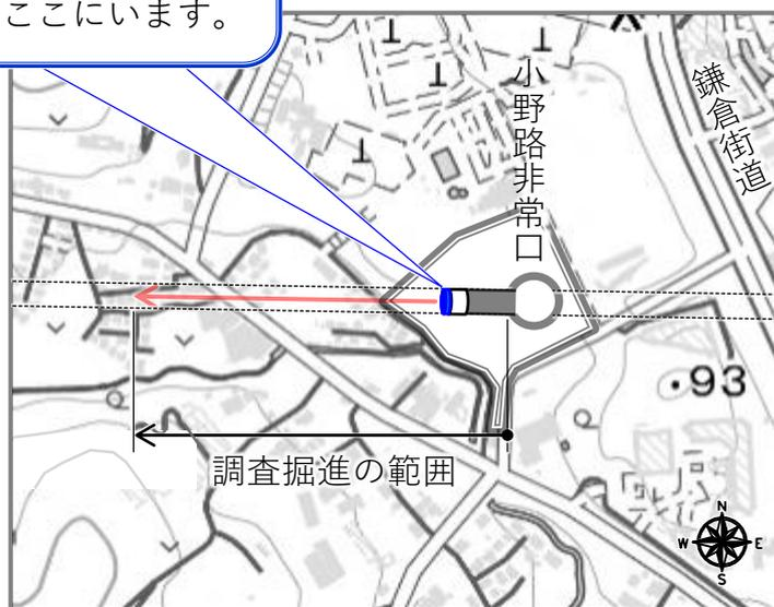
※ 調査掘進は、シールドマシンの後ろに繋ぐ一連の設備を収める長さまで行きます。途中で、段取り替えのため、一時的に掘進を停止する期間があります。
