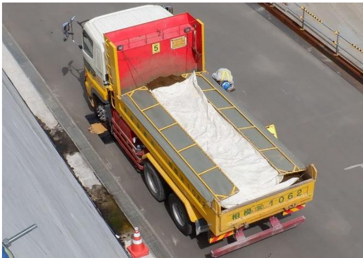
荷台への防じんシートの設置
