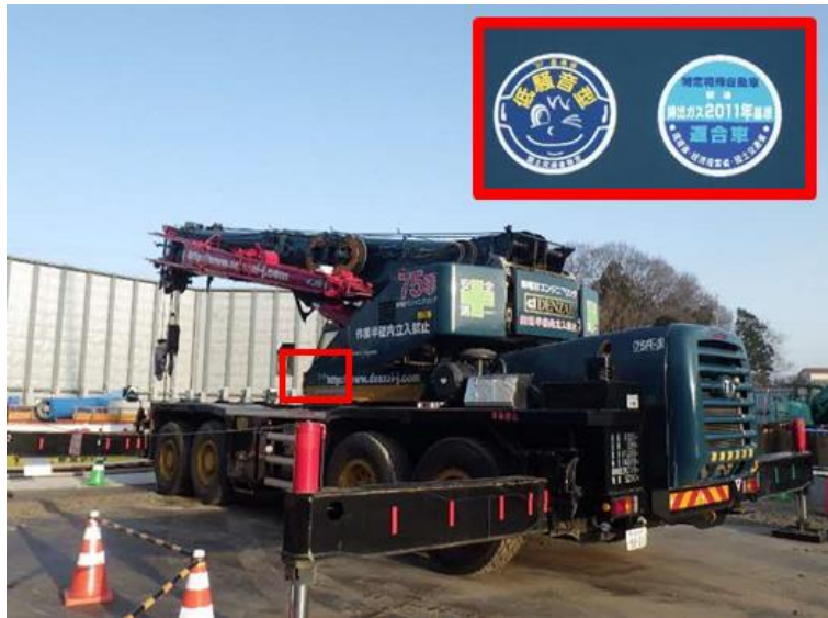
排出ガス対策型、低騒音型建設機械の使用
