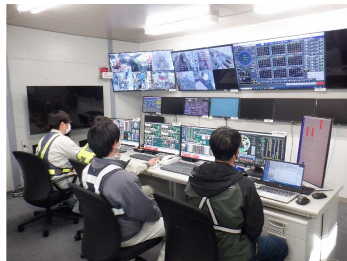
泥土圧の確認状況
