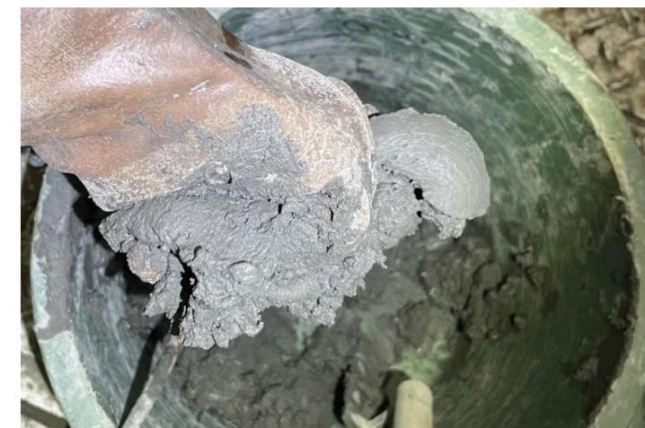
土砂サンプリング装置で採取した土砂
