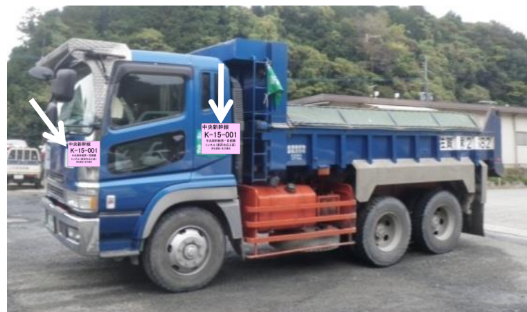
工事用車両への標識の明示
