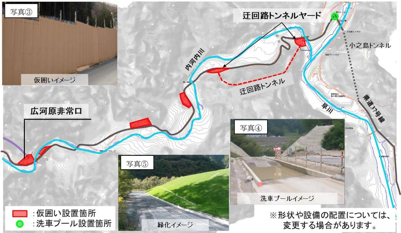
図3-2 1 広河原工事施工ヤードにおける動物、植物、生態系に関する計画面の環境保全措置
