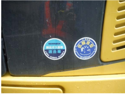
写真 6-3-1 排出ガス対策型、低騒音型 建設機械の採用
