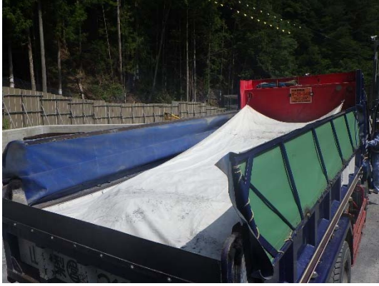
写真 6-4-7 運搬時の浸透防止シート設置状況
