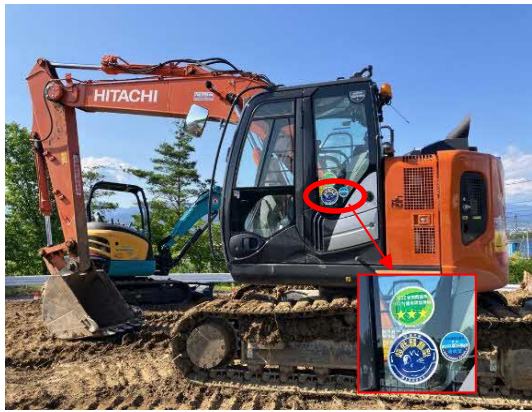
写真5-1-1 排出ガス対策型・低騒音型 建設機械の採用
