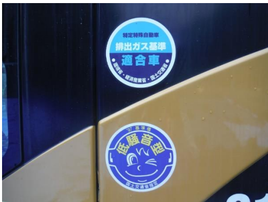
写真 5-13-1 排出ガス対策型、低騒音型 建設機械の採用
