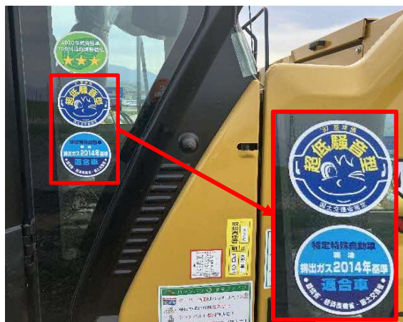
写真5-2-1 排出ガス対策型・低騒音型建設機械の採用
