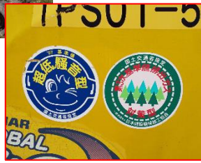
写真 5-3-1 排出ガス対策型・低騒音型建設機械の採用
