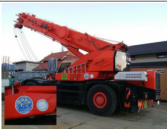
写真5-4-1 排出ガス対策型・低騒音型建設機械の採用
