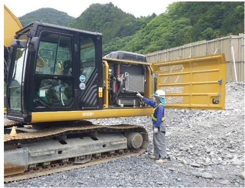
写真 5-13-2 建設機械の点検及び整備状 況
