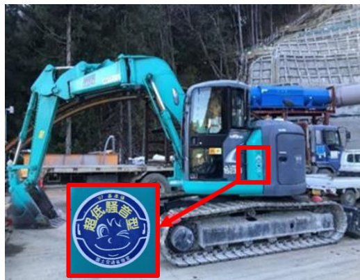
写真5-8-6 低騒音型建設機械の採用
