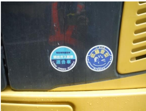
写真 5-12-1 排出ガス対策型、低騒音型 建設機械の採用
