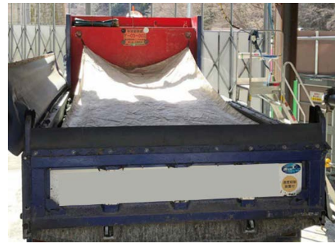
写真 6-4-16 運搬時の浸透防止シート 設置状況
