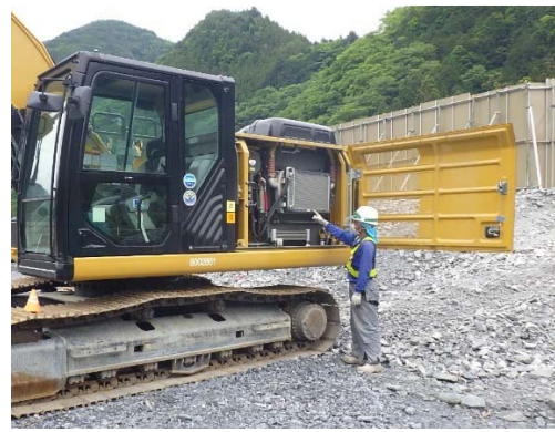
写真 6-7-2 建設機械の点検・整備
