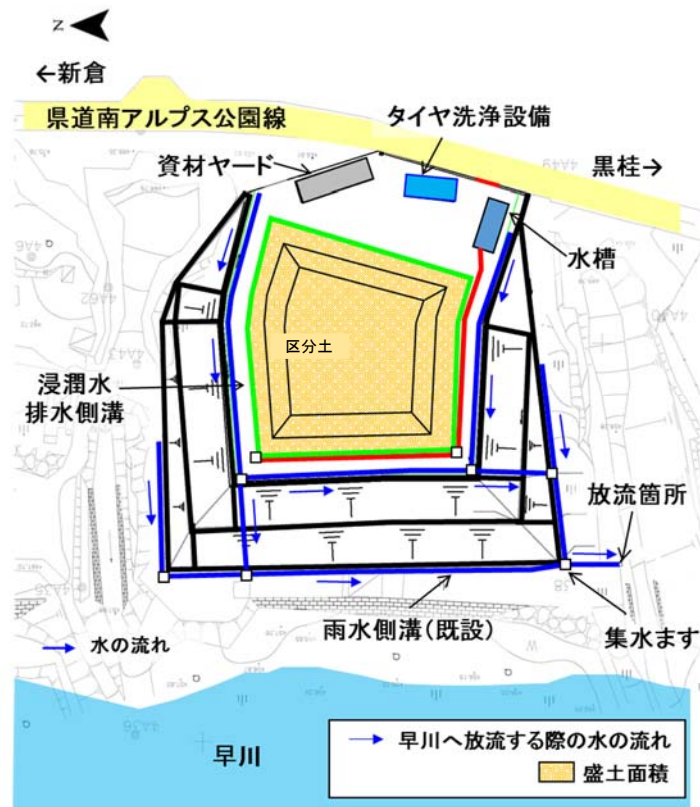
図 6-7-1(1) 改変区域及び排水設備の設置状況 (塩島地区 (南) 発生土仮置き場)
