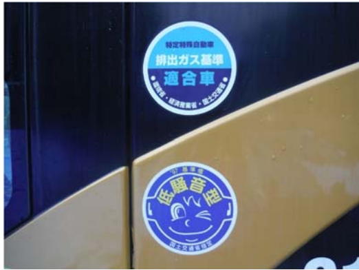
写真 6-7-1 排出ガス対策型、低騒音型 建設機械の採用
