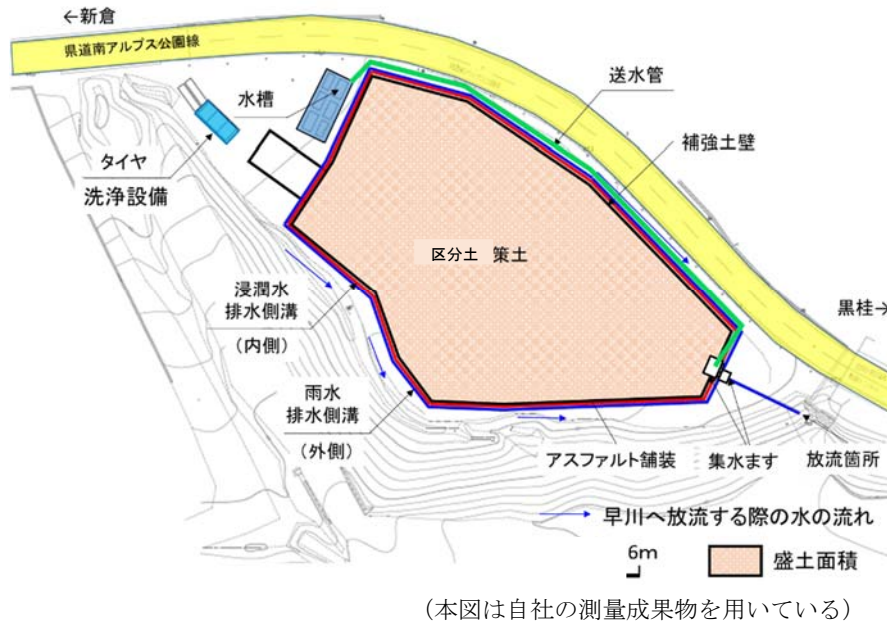
図 6-7-1(2) 変更区域及び排水設備の設置状況（塩島地区（下流）発生土仮置き場）
