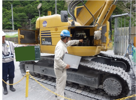
写真 6-5-2 建設機械の点検・整備
