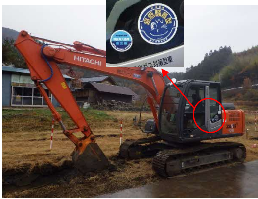
写真 6-8-1 排出ガス対策型・低騒音型 建設機械の採用
