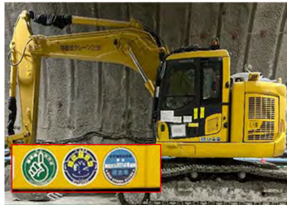
写真 4-1-5-1 排出ガス対策型、低騒音型建設機械の採用
