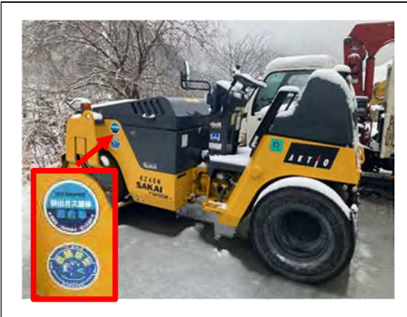
写真 4-1-9-1 排出ガス対策型、低騒音型建設機械の採用
