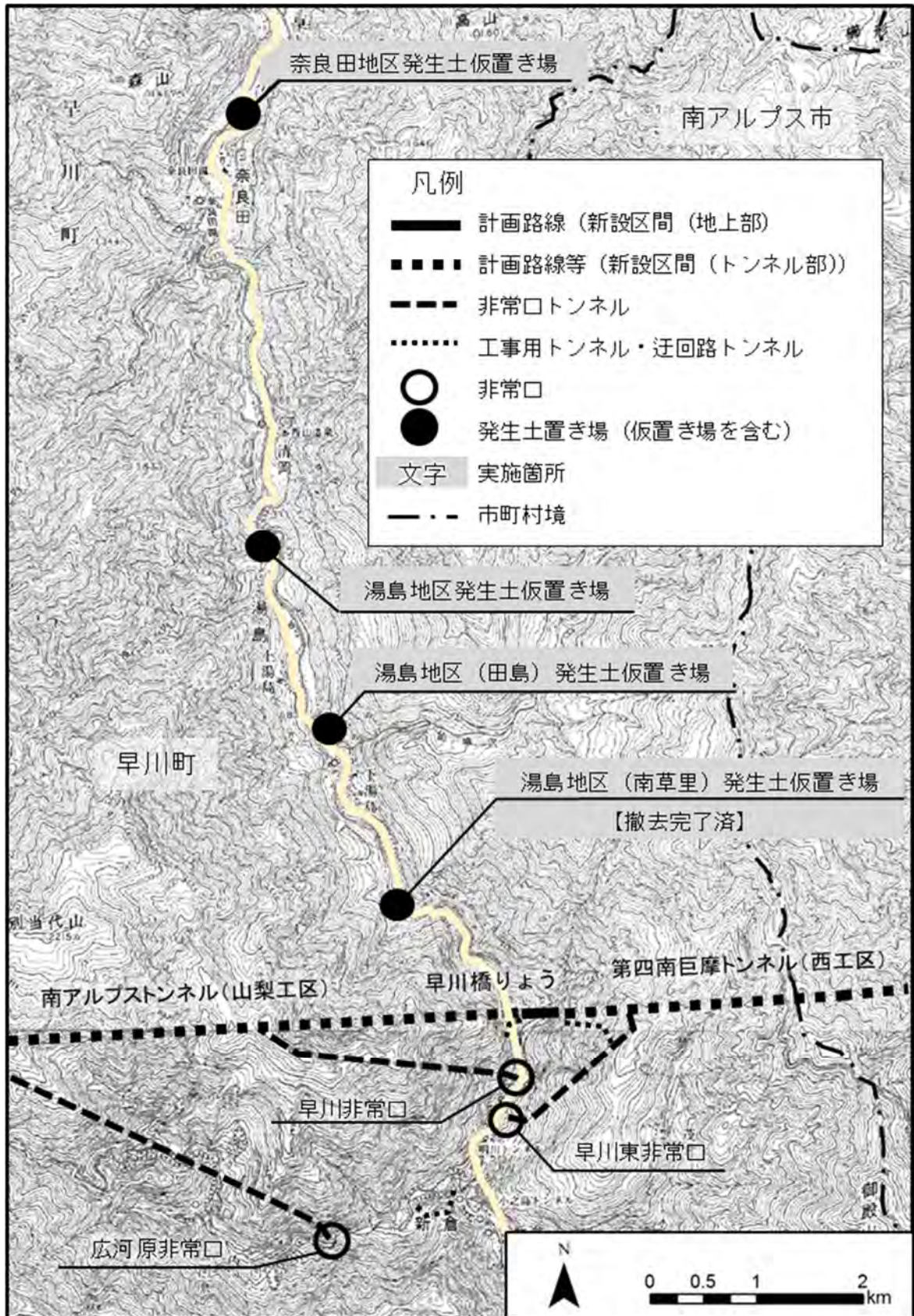
図 1-2-1 (6) 工事の実施箇所 (早川町内発生土置き場 (1))
