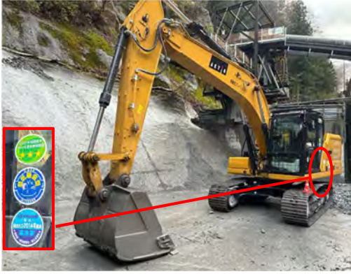
写真 4-1-7-1 排出ガス対策型、低騒音型建設機械の採用
