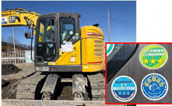
写真 4-1-2-1 排出ガス対策型、低騒音型建設機械の採用
