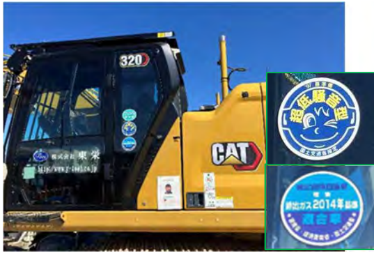
写真 4-1-1-1 仮囲いの設置、排出ガス対策型、低騒音型の建設機械の採用 (低騒音型建設機械の採用)
