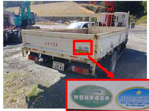
写真 4-1-9-18 低燃費車種の選定、積載の効率 化、運搬計画の合理化による運搬 距離の最適化 (低燃費車種の選定)
