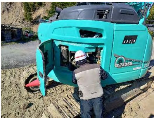
写真 4-1-10-3 建設機械の点検及び整備による性能維持
