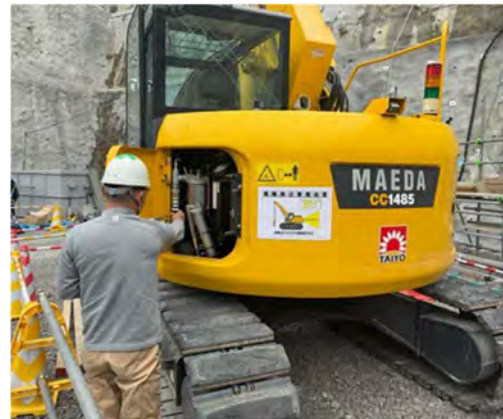
写真 4-1-8-2 建設機械の点検及び整備による性能維持
