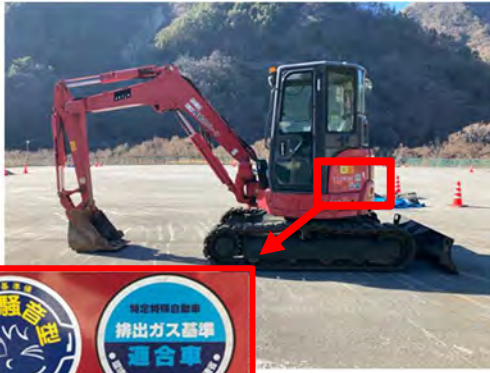
写真 4-1-10-1 排出ガス対策型、低騒音型建設機械、防音シートの採用
