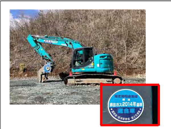
写真 4-1-6-1 排出ガス対策型建設機械の採用
