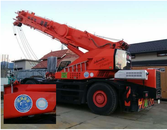
写真4-1-3-1 排出ガス対策型・低騒音型建設機械の採用
