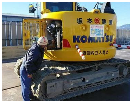
写真4-1-4-3 建設機械の点検・整備
