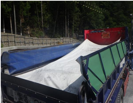
写真 4-1-11-5 運搬時の防じんシート 敷設状況
