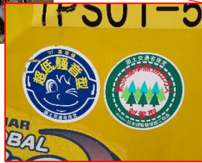
写真 4-1-2-1 排出ガス対策型・低騒音型 建設機械の採用
