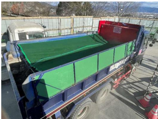
写真4-1-6-7 荷台への防じんシート敷設
