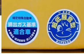
写真4-1-5-1 排出ガス対策型・低騒音型 建設機械の採用
