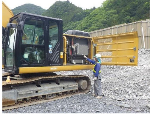
写真 4-1-11-2 建設機械の点検及び整備
