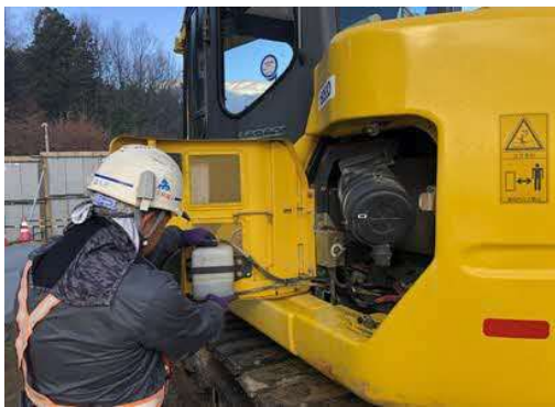
写真4-1-5-3 建設機械の点検及び整備による性能維持
