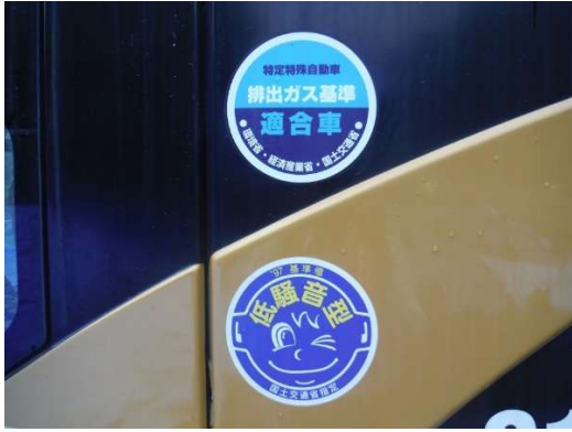
写真 4-1-10-1 排出ガス対策型、低騒音型 建設機械の採用
