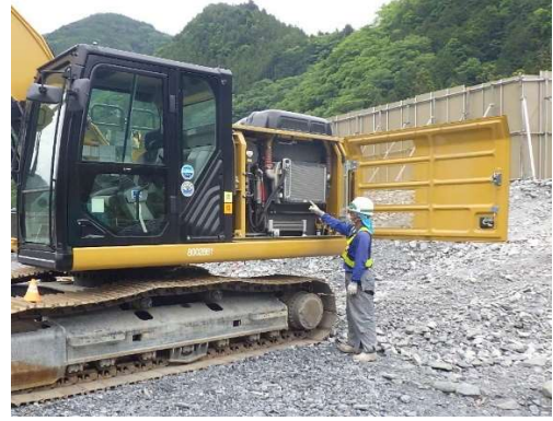
写真 4-1-10-2 建設機械の点検・整備
