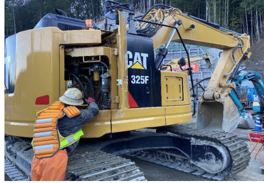
写真4-1-6-2 建設機械の点検・整備
