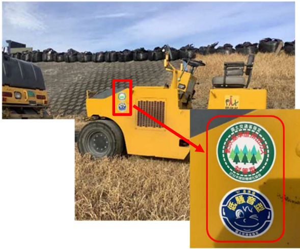
写真4-1-1-1 排出ガス対策型・低騒音型建設機械の採用
