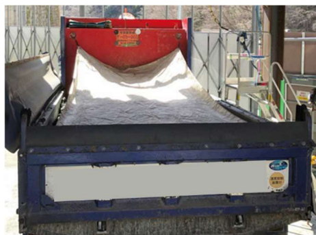
写真 4-1-7-7 運搬時の防じんシート 設置状況
