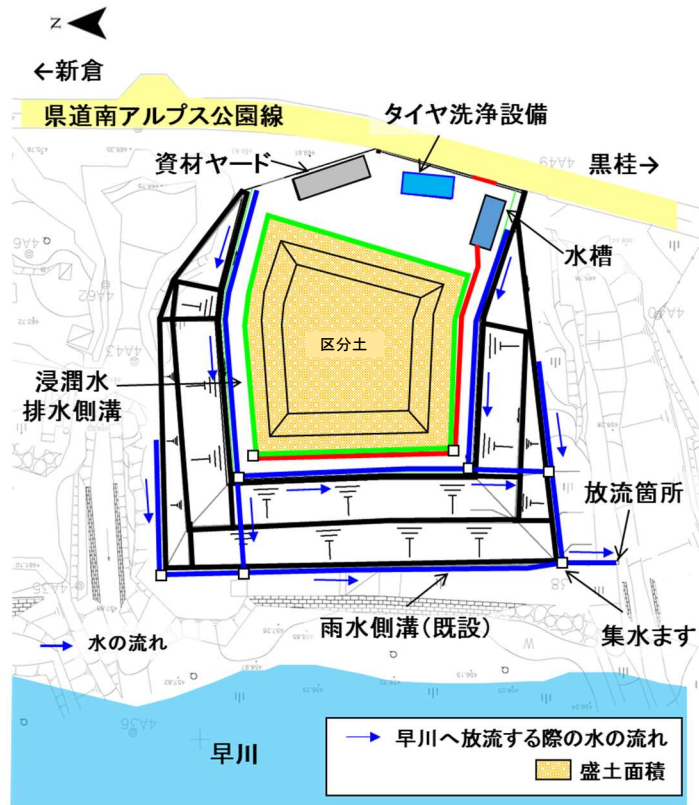
図 参 3-10-1(1) 変更区域及び排水設備の設置状況 (塩島地区 (南) 発生土仮置き場)
