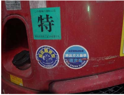
写真4-1-2-1 排出ガス対策型、低騒音型 建設機械の採用
