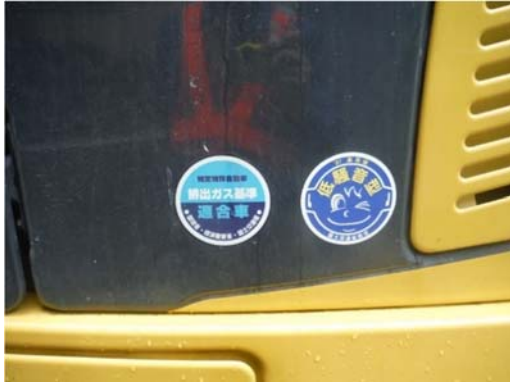
写真4-1-3-1 排出ガス対策型、低騒音型 建設機械の採用
