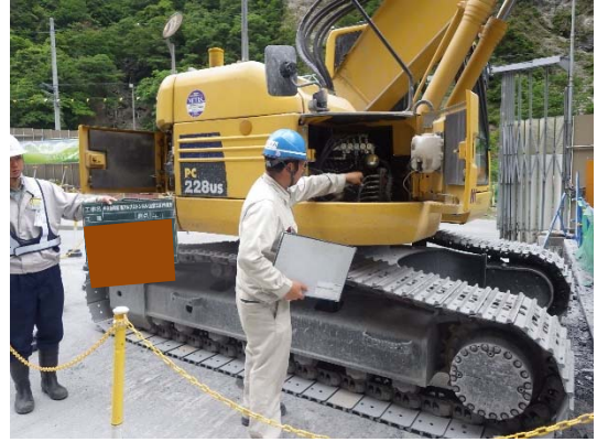
写真4-1-2-2 建設機械の点検・整備
