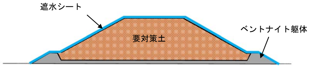
図 2-5 (3) 塩島地区 (南) 発生土仮置き場における主な施工手順 (仮置き)
