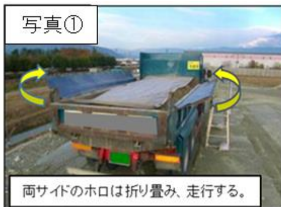
荷台への浸透防止シート等の設置
