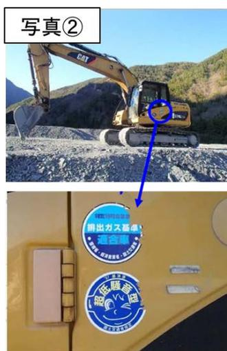
写真② 低騒音・排出ガス対策型建設機械の使用
