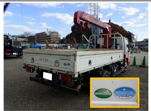
写真-4 低公害型の工事用車両の選定（地点05）
