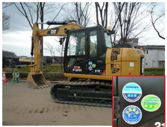
写真-6 低騒音型建設機械の採用（地点 03）
