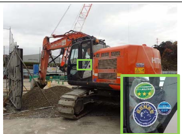
写真-1-2 低騒音型建設機械の採用状況 (地点 05)
