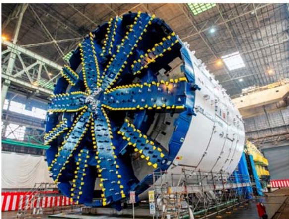
写真 3-4-7(1) シールド機完成状況（工場） （令和3年3月時点）
