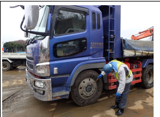
写真-1-2 資材及び機械の運搬に用いる車両の点検及び整備の状況（地点 05）
