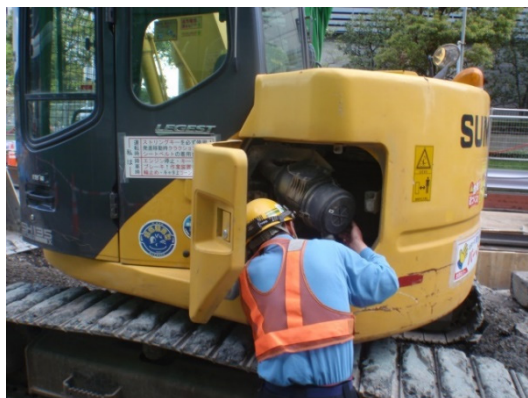
写真-1-1 建設機械の点検及び整備による性能維持状況 (地点 01)
