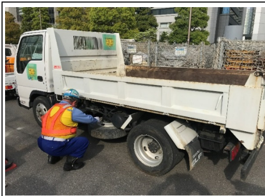
写真-1-1 資材及び機械の運搬に用いる車両の点検及び整備の状況（地点 01）
