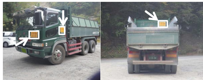
ダンプトラックの標識の明示状況
