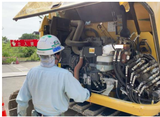
写真 4-1-4-5 建設機械の点検及び整備による性能維持
