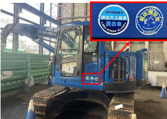
写真 4-1-5-3 排出ガス対策型建設機械の採用、低騒音型建設機械の採用
