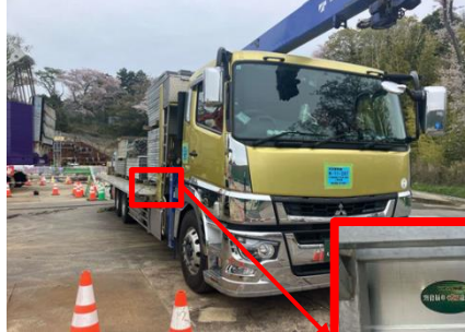
写真 4-1-4-1(2) 仮囲い・防音シート等の設置(エンジン周りに防音シートを設置)
