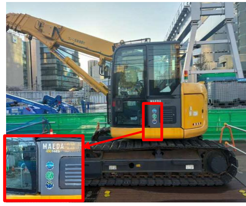
写真 4-1-2-2 排出ガス対策型建設機械の採用、低騒音型建設機械の採用
