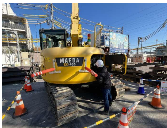
写真 4-1-4-3 建設機械の点検及び整備による性能維持
