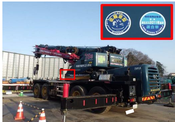
写真 4-1-6-3 排出ガス対策型建設機械の採用、低騒音型建設機械の採用
