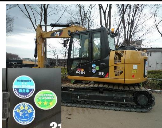
写真 4-1-7-2 排出ガス対策型建設機械の採用、低騒音型建設機械の採用
