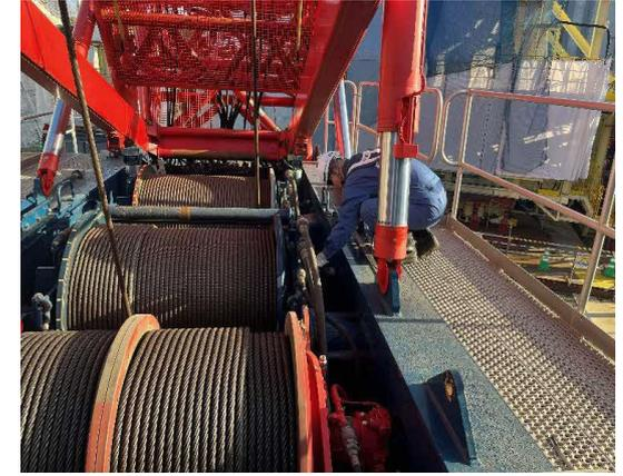
写真4-1-6-4 建設機械の点検及び整備による性能維持
