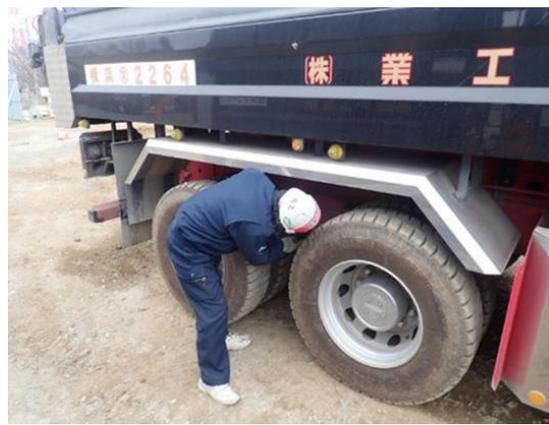
写真4-1-7-10 資材及び機械の運搬に用いる車両の点検及び整備による性能維持
