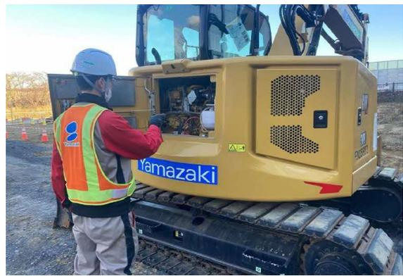
写真4-1-5-4 建設機械の点検及び整備による性能維持
