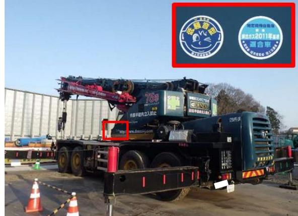
写真4-1-6-3 排出ガス対策型建設機械の採用、低騒音型建設機械の採用
