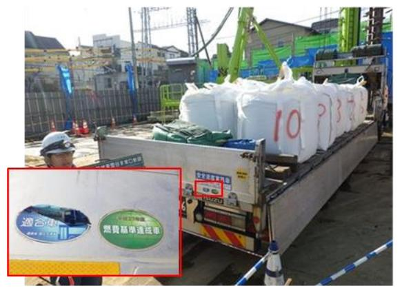
写真4-1-4-10 低燃費車種の選定、積載の効率化、運搬計画の合理化による運搬距離の最適化、低公害型の工事用車両の選定
