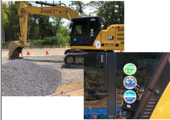
写真4-1-5-2 排出ガス対策型建設機械の採用
