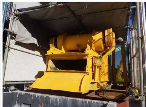
写真4-1-1-11 建設汚泥の脱水処理
