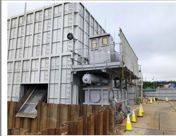
写真 4-1-5-13 建設汚泥の脱水処理
