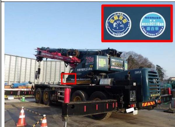
写真4-1-6-3 排出ガス対策型建設機械の採用、
