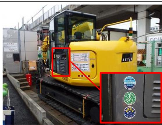
写真4-1-1-2 排出ガス対策型建設機械の採用、低騒音型建設機械の採用
