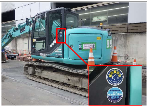
写真4-1-1-2 排出ガス対策型建設機械の採用
