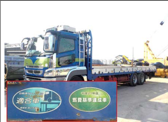
写真4-1-1-11 低燃費車種の選定、積載の効率化、運搬計画の合理化による運搬距離の最適化、低公害型の工事用車両の選定
