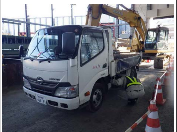
写真4-1-5-10 資材及び機械の運搬に用いる車両の点検及び整備による性能維持
