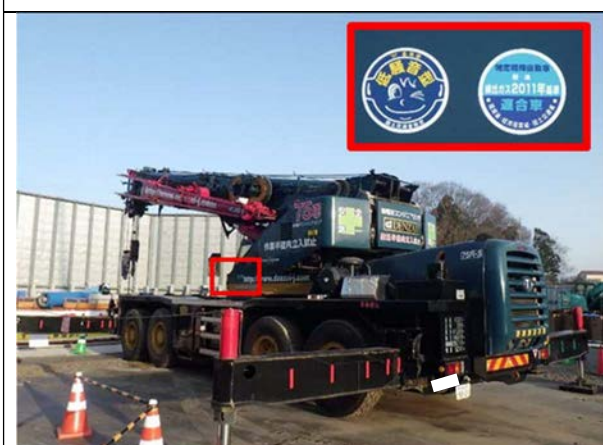
写真4-1-5-3 排出ガス対策型建設機械の採用、低騒音型建設機械の採用
