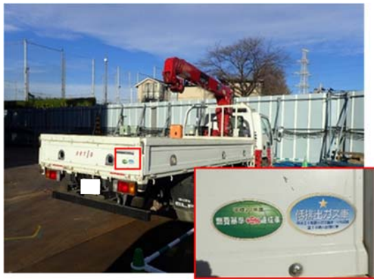
写真4-1-5-9 低燃費車種の選定、積載の効率化、運搬計画の合理化による運搬距離の最適化、低公害型の工事用車両の選定
