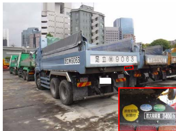
写真4-1-3-9 低燃費車種の選定、積載の効率化、運搬計画の合理化による運搬距離の最適化、低公害型の工事用車両の選定
