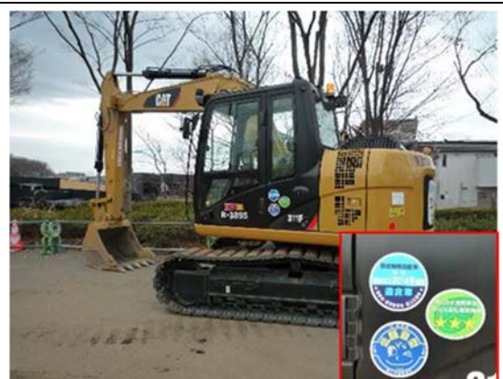
写真4-1-7-2 排出ガス対策型建設機械の採用、低騒音型建設機械の採用
