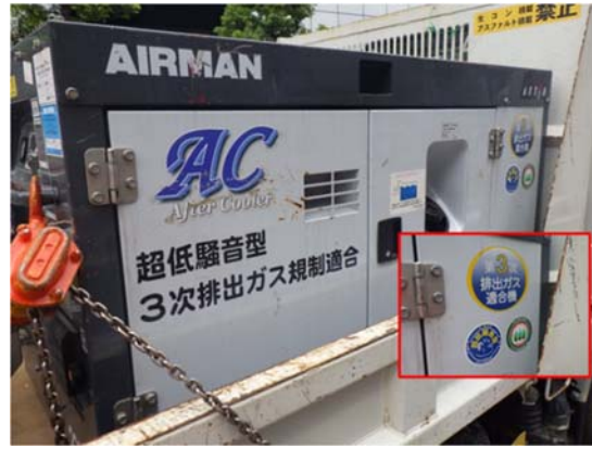
写真4-1-1-2 排出ガス対策型建設機械の採用
