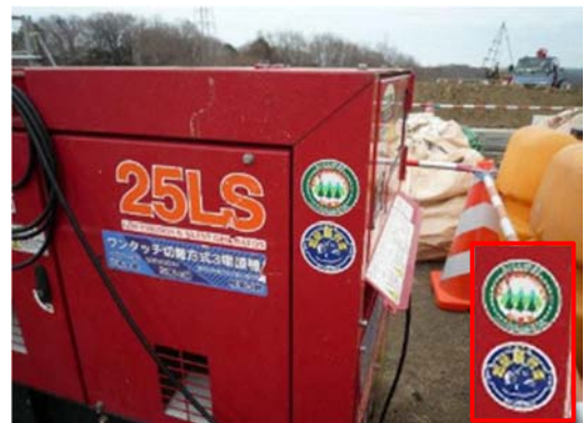
写真4-1-7-12 低炭素型建設機械の採用
