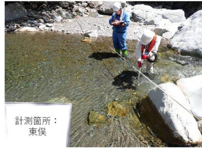
図 6 河川流量の計測状況（東俣での例）
