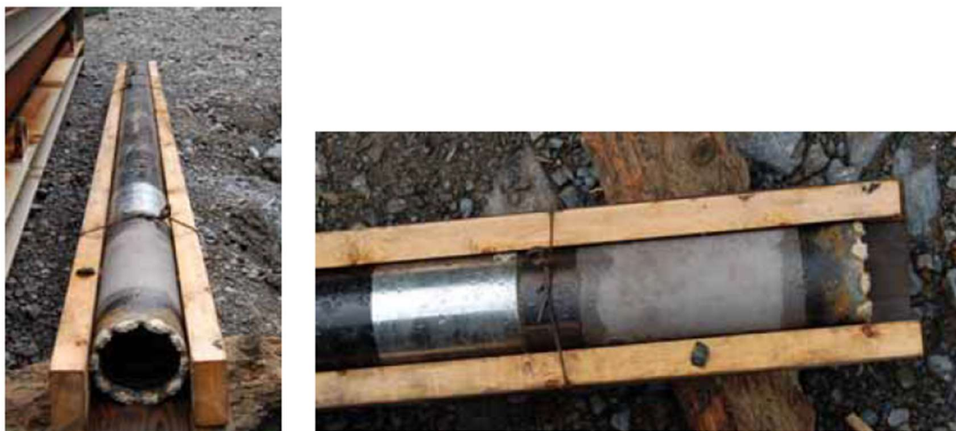
写真 1 コア採取ツール（コアチューブ：参考）
