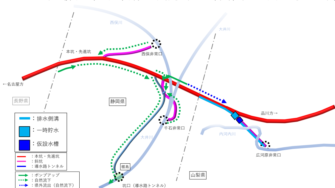
図 4 県外流出の流れと設備計画平面図略図
