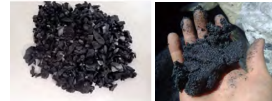
図4 岩石片 (スライム) の状況 (左: 孔口から50m付近、右: 孔口から145m付近)
