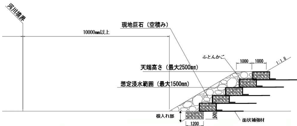
図 6 5 盛土法尻構造物詳細図
