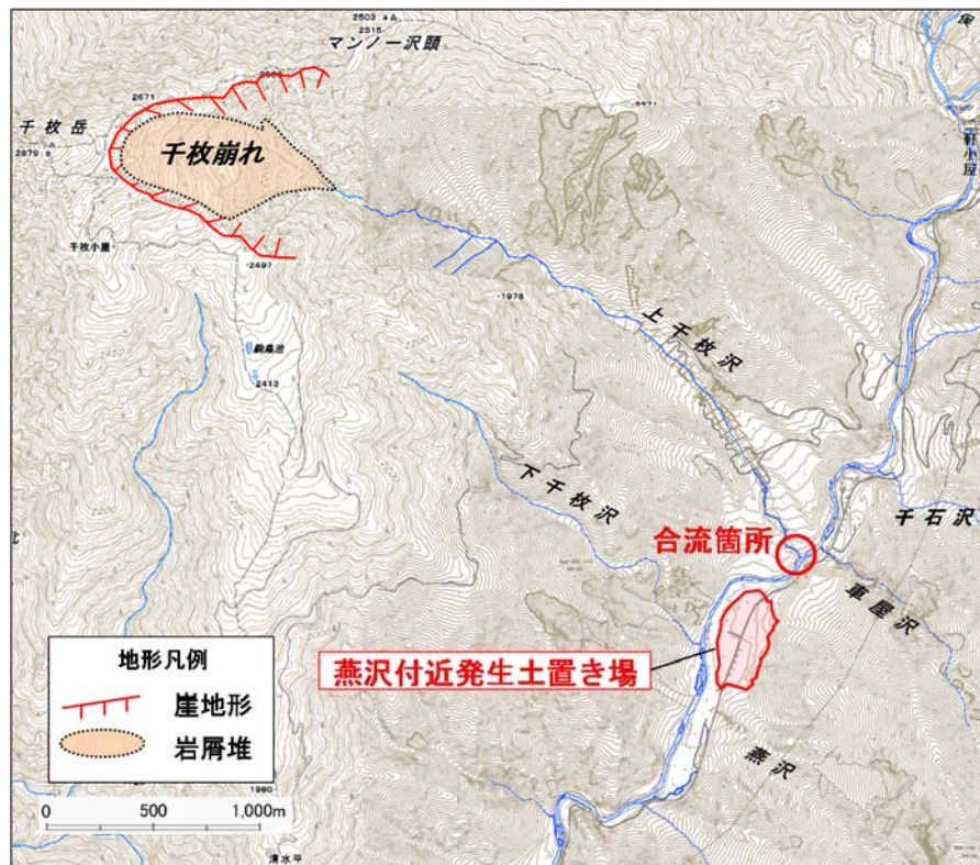
図 6-4 燕沢付近の発生土置き場と崩壊地（千枚崩れ）との位置関係
