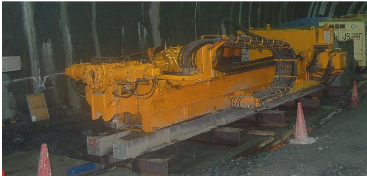
写真 先進ボーリングマシン
