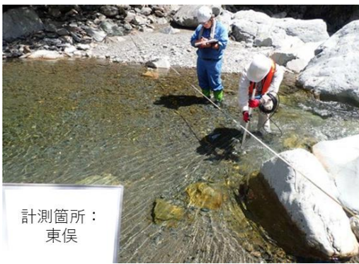
図42.河川流量の計測状況（東俣）
