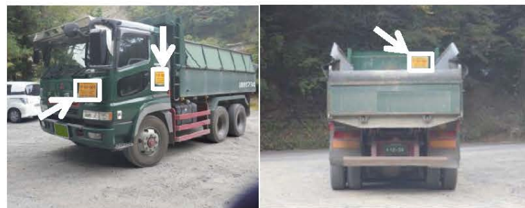
ダンプトラックの標識の明示状況
