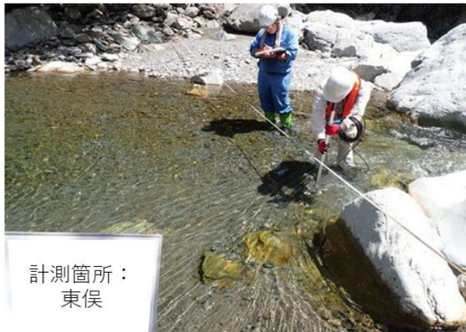
河川流量の計測状況（東俣）
