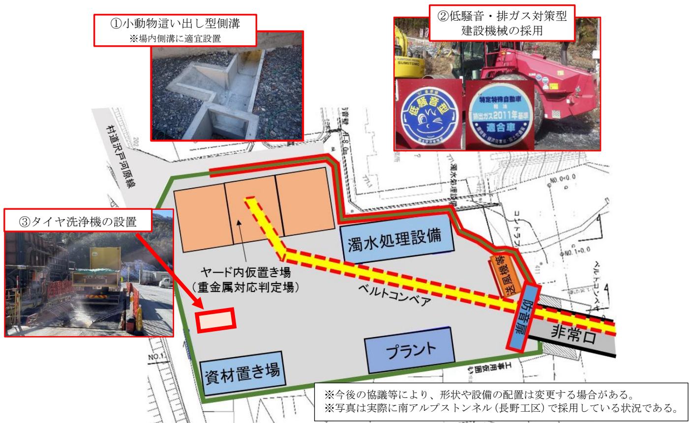
図 3-23 動物・植物・生態系に関する計画面での環境保全措置（小渋川工事施工ヤード）
