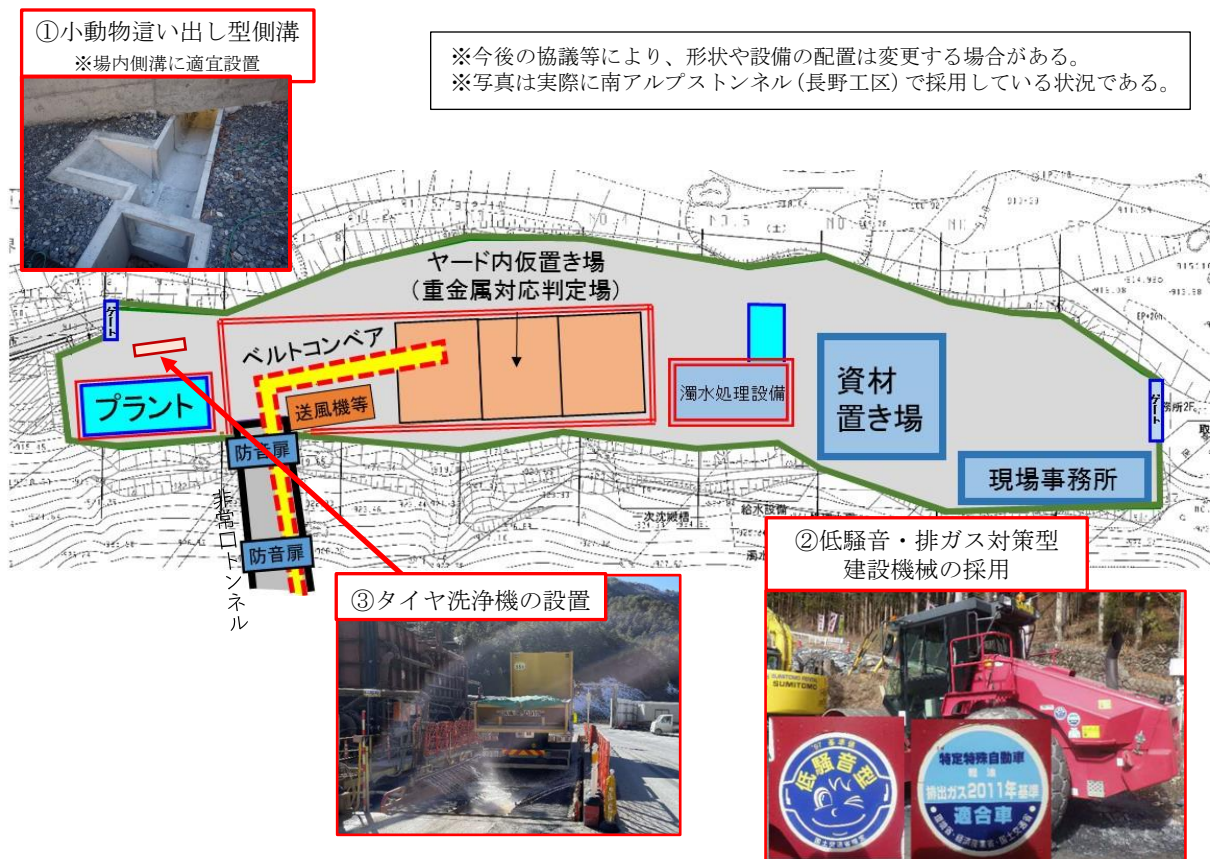
図 3-21 動物・植物・生態系に関する計画面での環境保全措置（除山工事施工ヤード）
