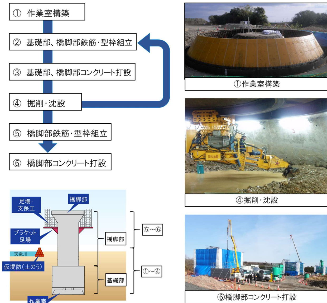
図 2-8 下部工（ケーソン基礎）の施工手順
